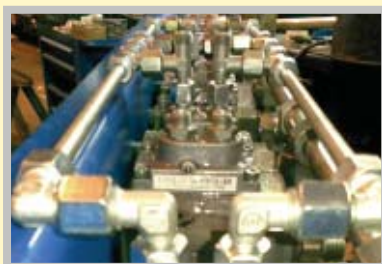
Distributeurs hydrauliques avec soupapes de sécurité
