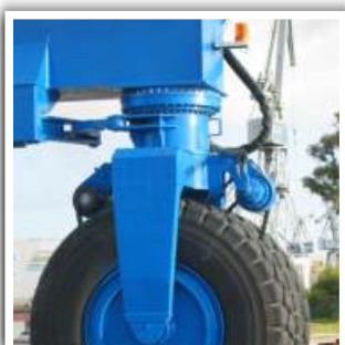
DIRECTION ROBUSTE, PROPORTIONNELLE AU RAYON DE ROTATION
