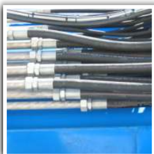
TUYAUTERIE HYDRAULIQUE EN ACIER INOXYDABLE
